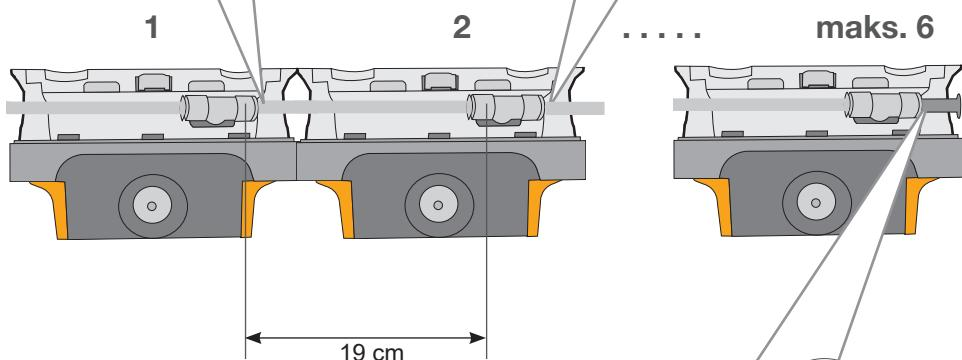
Kod redne montaže i paralelnog načina rada neophodno je da minimalni protok po dozatoru od 2 l/min. bude zagarantovan!
