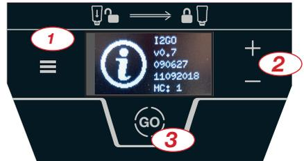
3. Mit der +/- Taste das Menü „COUNTER“ anwählen und mit der GO-Taste in das Untermenü wechseln
