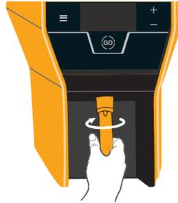
3. Ziehen Sie den Abgabestutzen samt Spritzschutzsicherung nach unten ab.
